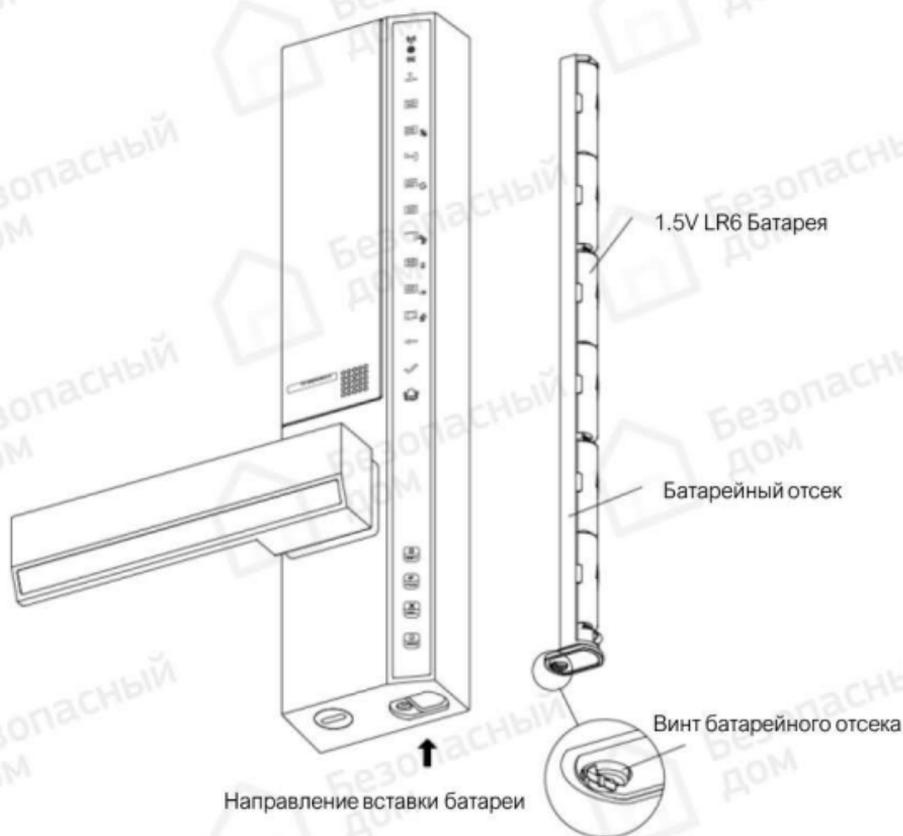
1. Открутите винт батарейного отсека против часовой стрелки монетой или отверткой, вытащите батарейный отсек и вставьте 6 батарей 1.5V LR6 AA.
